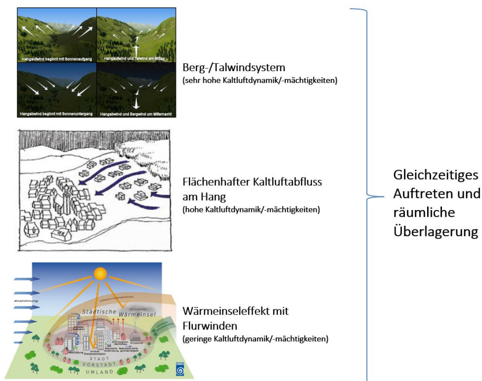
Abbildung 6: Stadtklimatisch relevante Prozesse (eigene Darstellung auf Basis der Quellen: The COMET Program 2017(oben), MVI 2012 (Mitte), DWD 2023b (unten))
